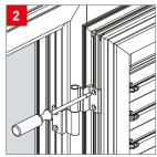
SVITAMENTO CERNIERA Negli infissi già installati svitare la cer-niera per l'inserimento del catenaccio
