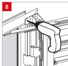
FISSAGGIO STAFFA Forare il profilo telaio con una punta Ø 4 in corrispondenza dei fori della staffa e fissare con i rivetti.
