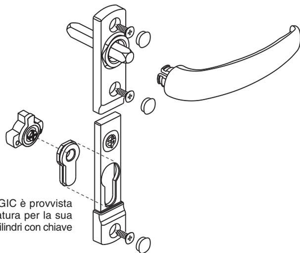
La maniglia MAGIC è provvista di un copri serratura per la sua applicazione su cilindri con chiave a spillo
