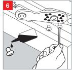
REGISTRAZIONE SNODO Questa operazione si effettua ad anta aperta bloccata. Innestare provvisoriamente il blocchetto del braccio **c** nella pista del profilo telaio senza bloccarlo. Registrare lo snodo nella posizione fun-zionale. Si consiglia di mettere sulle due viti del collante frenafiletti e riavvitare.
