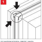
**SCANTONATURA PISTE ANTA** Eseguire una scantonatura sulle piste dell'anta per permettere l'inserimento del corsolo del braccio nella scanalatura del corsolo del del corsolo del scanalatura del corsolo del superiore e del catenaccio sagomato nella scanalatura verticale.
