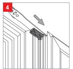
APPLICAZIONE BRACCIO Inserire il corsoio di plastica nella pista superiore dell'anta già scantonata.
