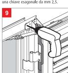
FISSAGGIO STAFFA Forare il profilo telaio con una punta Ø 4 in corrispondenza dei fori della staffa e fissare con i rivetti.
