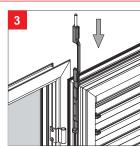
**INSERIMENTO CATENACCIO** Inserire il catenaccio sagomato completo delle sue parti **D**, **E**, **F** e **G** nella pista verticale. Posizionare la cerniera correttamente all'interno della sagomatura del terminale e avvitare (Dis.5). Dove l'altezza della persiana lo richiede, sostituire il ponte di collegamento sul catenaccio con un'asta cremonese di una lunghezza otti-male per la manovrabilità del terminale.
