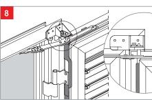
MONTAGGIO STAFFA Posizionare la staffa **A** con il perno del terminale sagomato **D** innestato sull'asola lasciando uno spazio tra la parte superiore dell'anta e la base della staffa minimo di 3 mm.
