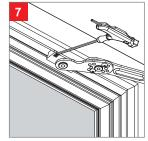
FISSAGGIO BRACCIO Serrare i due grani del blocchetto con una chiave esagonale da mm 2,5.
